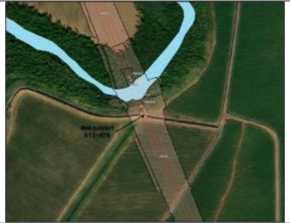
Figura 31. Ubicación de box culvert proyectado sobre K12+978
